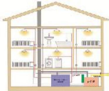
Les systèmes de micro-cogénération ont pour principe de produire localement et de façon simultanée, l'énergie nécessaire pour le chauffage et l'électricité d'un immeuble d'habitation ou d'une maison individuelle.
